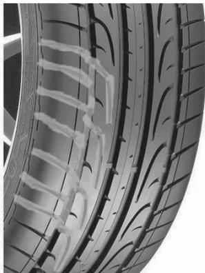
Además de una correcta presión de aire, los dibujos de la banda de rodamiento permiten la dispersión de agua u otras sustancias que se encuentren en el pavimento; permitiendo un contacto eficiente entre la cubierta y el suelo.
